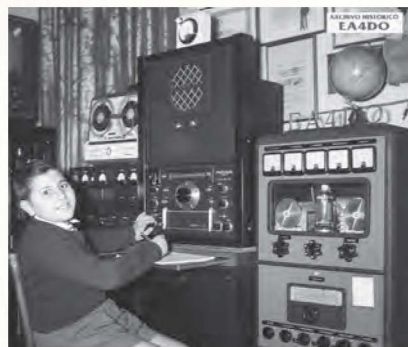
Isi, EA4-599.U, en 1957, ante el receptor National HRO-50 R (rack para el juego de bobinas intercambiables) de la estación EA4DO. A la izquierda "El tres de bastos" y a la derecha "La Pintora", transmisores construidos ambos por EA4DY.
