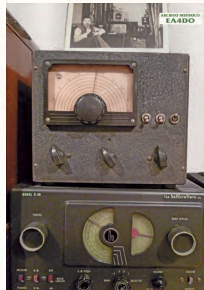
Conversor construido en 1950 por Rafael Zayas para Felipe Pons, EA4DF, con las bandas de 40, 20 y 10 metros, sobre receptor Hallicrafters S-38.
